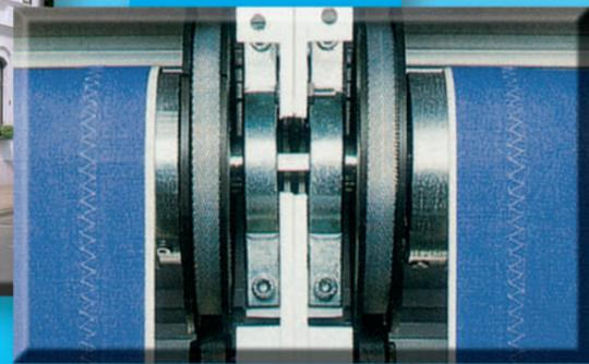
Umlenkbogen mit Tuchumlenkrolle für Beschattungen mit zusätzlichem senkrechten Ausfall. Der kleine Umlenkradius ermöglicht einen geringen Abstand zwischen Markise und Wintergarten. Auf Edelstahlbozen gelagerte Kunststoffrollen sorgen für eine verschleißarme Bandführung.
